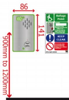
L'OSB n'est pas fourni avec une boîte arrière car il peut être utilisé avec n'importe quel style de coffret, sailli ou encastré. (Attention : pour pouvoir placer un presse-étoupe à l'arrière de la boîte celle-ci doit faire au minimum 35mm de profondeur). L'appareil doit être installé entre 900 mm à 1200 mm du sol suivant les réglementations d'accès pour les handicapés.
